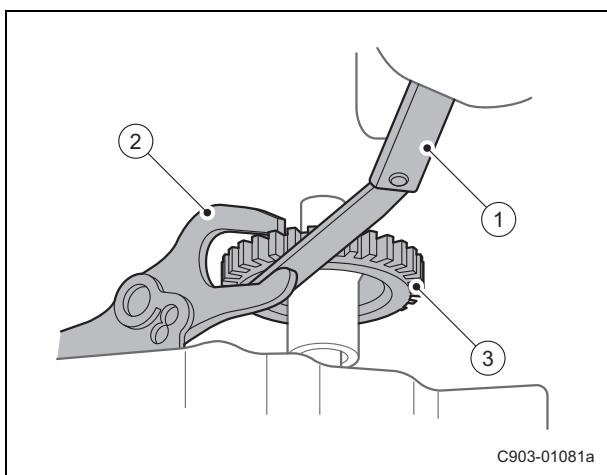
2. 测量倒档轴拨叉的间隙。
