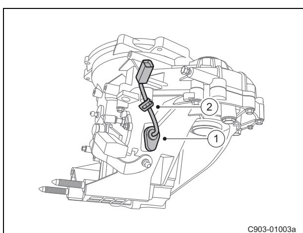
(d). 拆卸空档开关固定螺栓 1。
