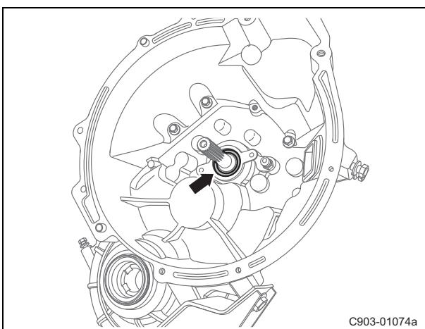
(d). 使用合适工具拆卸变速器前油封。
