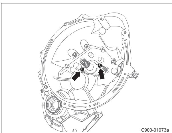
(c). 拆卸离合器分离轴承支撑套固定螺栓。
