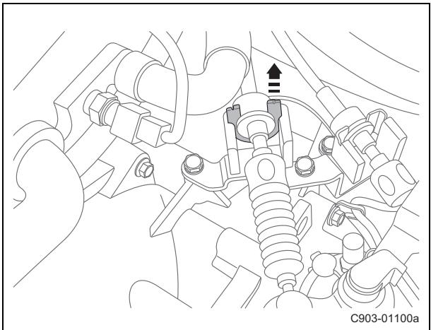
(m).拆卸换档拉索弹簧卡片。
