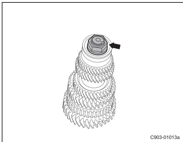
(c). 使用合适的工具拆卸副轴后端固定螺母。
