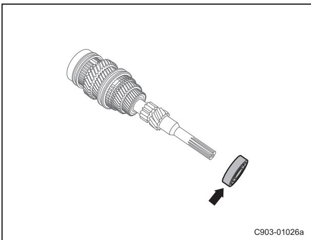
(c). 使用合适的工具拆卸主轴前轴承。
