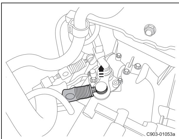
(k). 拆卸变速器侧换档拉索球头。
