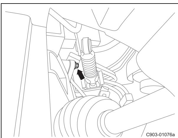
(e). 拆卸空档开关固定螺栓。
