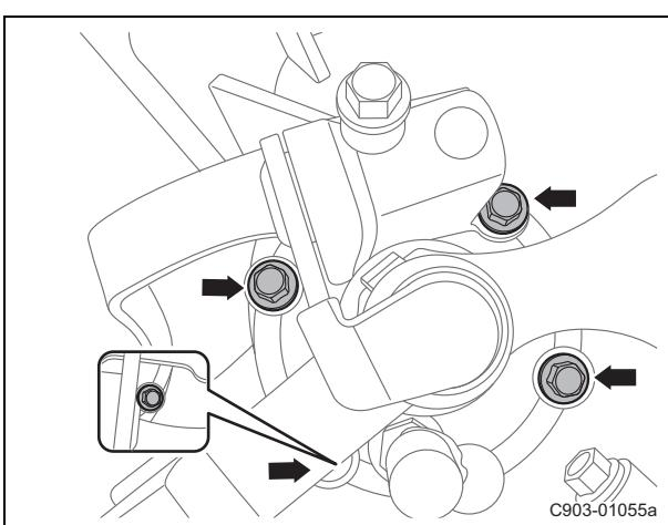
(c). 拆卸控制轴总成固定螺栓。
