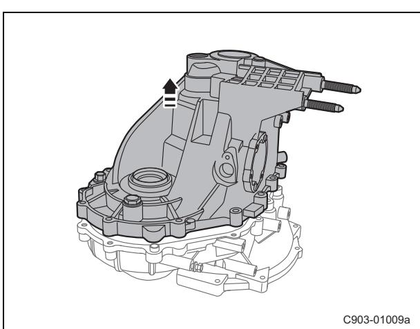
(k). 使用合适的工具拆卸变速器壳体。
