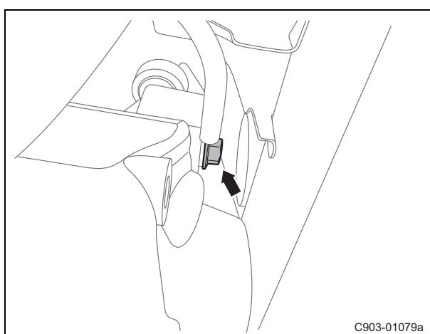
(h). 拆卸变速器左侧接地线固定螺栓。
