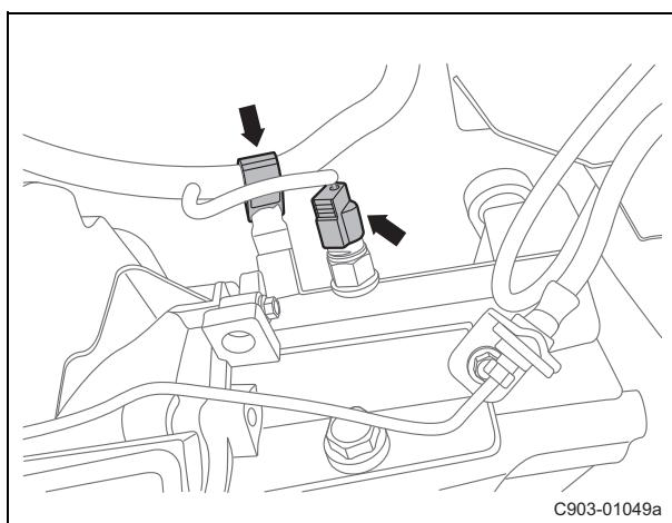
(f). 断开倒车灯开关总成线束连接器。
