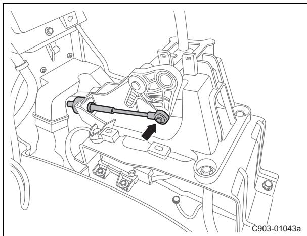
(c). 使用合适工具拆卸换档拉索球头。
