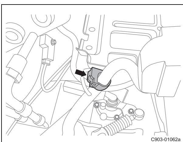
(o). 拆卸发动机控制模块 (ECM) 线束卡扣。
