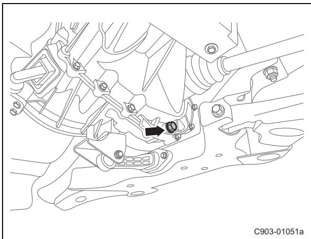
(a). 排空变速器油，安装变速器放油螺塞。
