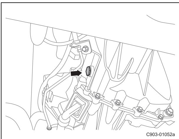
(c). 拆卸变速器加油螺塞。
