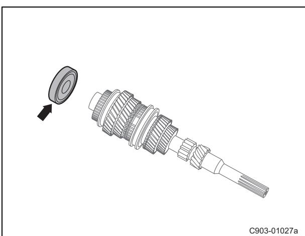
(d). 使用合适的工具拆卸主轴后端轴承。
