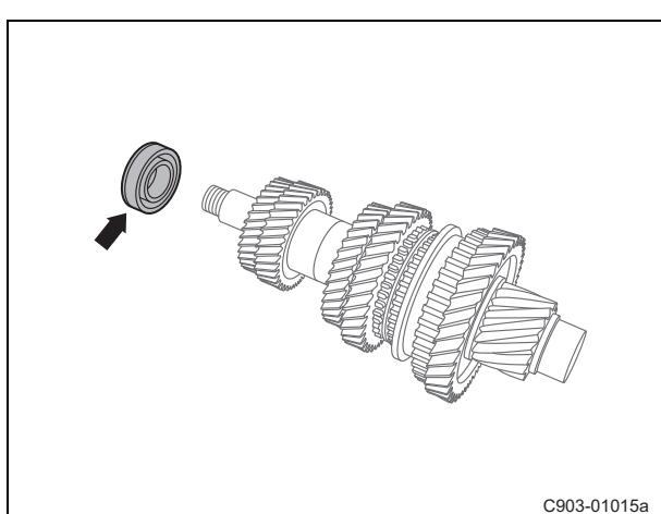
(e). 使用合适的工具拆卸副轴后端 2 号轴承。
