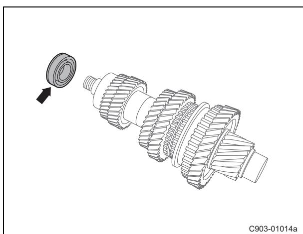
(d). 使用合适的工具拆卸副轴后端 1 号轴承。
