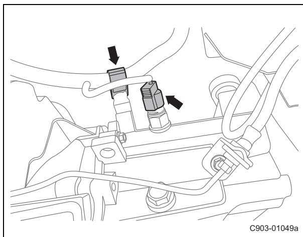
(c). 断开倒车灯开关总成线束连接器。
