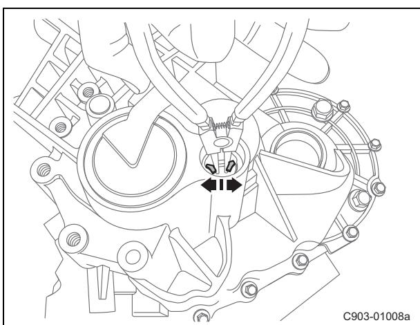
(j). 使用卡簧钳使卡簧张开，脱开副轴后端轴承。
