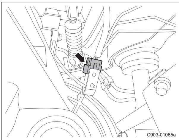
(c). 断开空档开关的线束连接器。
