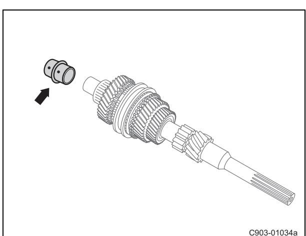
(k). 拆卸 4、5 档齿轮滚针轴承套。
