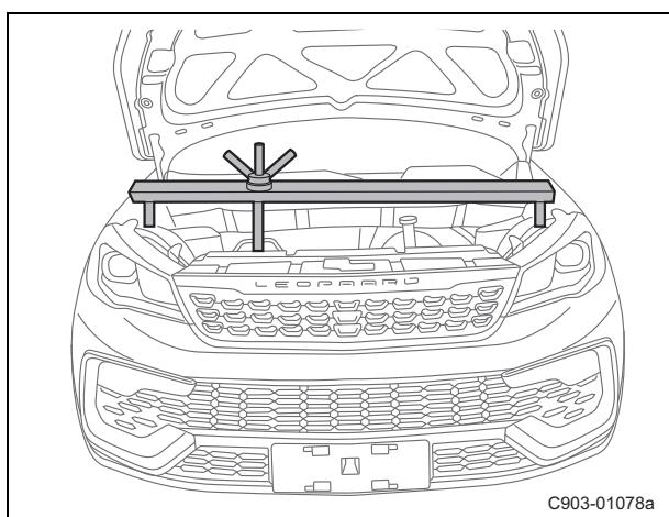
(u). 安装发动机吊架。
